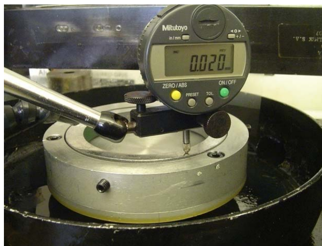
Figura 3.12 Uso de reloj de aguja para medir diferencia de alturas en la superficie del disco.
