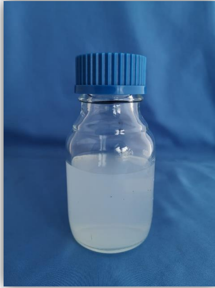
Figura 11. Dispersión de QDs de g-C 3 N 4 por ultrasonido.
