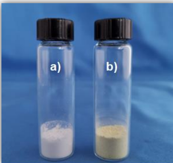
Figura 7. Cambio de color de la melamina a) antes y b) después del tratamiento térmico para síntesis de nitruro de carbono grafitico ( g\text{-C}_3\text{N}_4 ).
