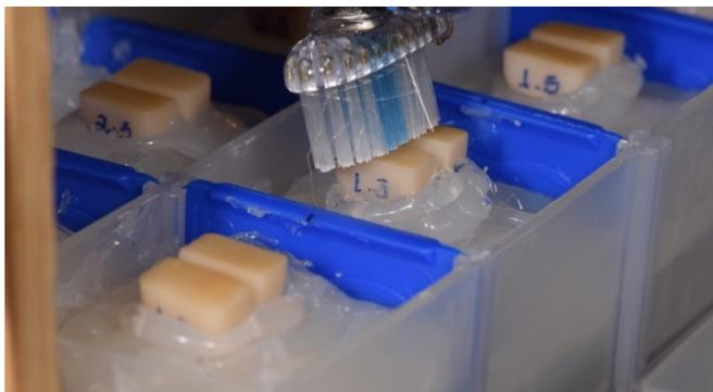
*Figura 23. Muestras Fijas con silicón transparente.*
