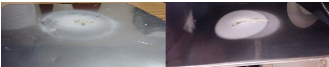
Figura 7. Halos generados en un colector de acero a partir de una solución de PBS/CPSL (izquierda) y PBS/CPSL (derecha), ambas adicionadas con el probiótico.
