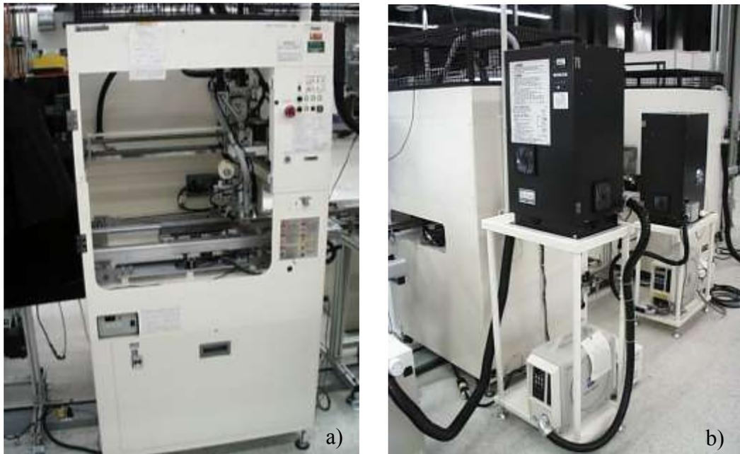
**Figura 4.3** Equipo de soldadura por haz de luz, a) lado frontal, b) lado lateral.
