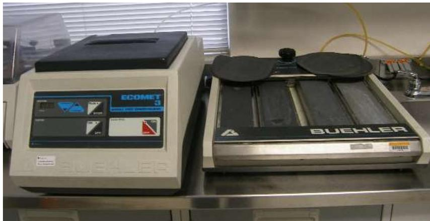
**Figura 4.7.** Equipo utilizado para el lijado grueso y fino de las muestras evaluadas.
