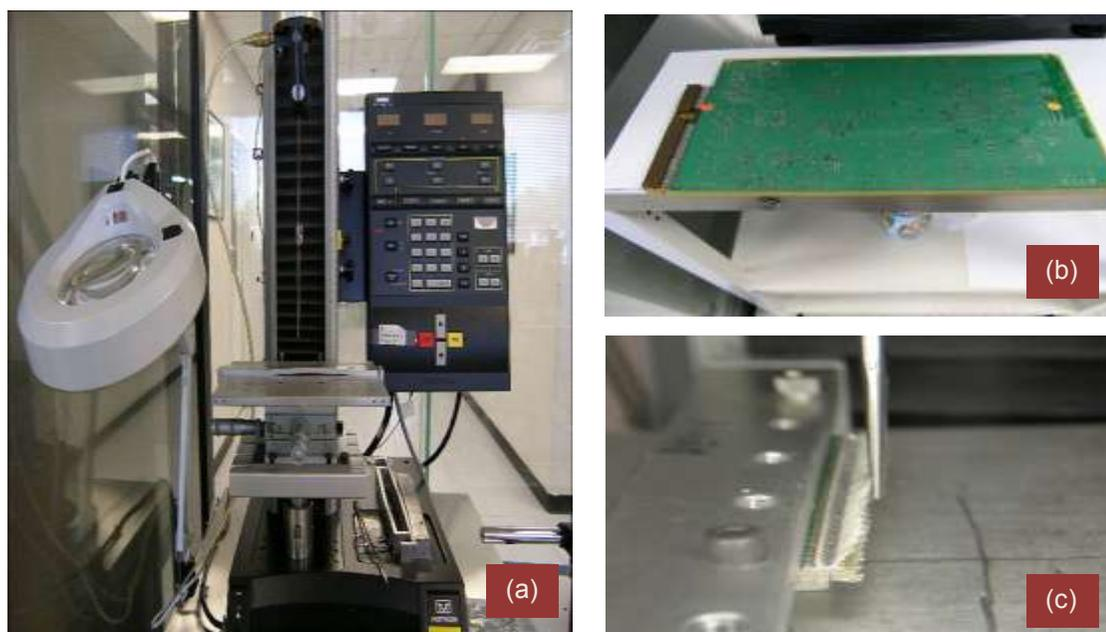
**Figura 4.5** (a) Equipo electromecánico utilizado para llevar a cabo los ensayos de tensión de las condiciones seleccionadas, (b) seccionado de la PCB, (c) operación del ensayo.
