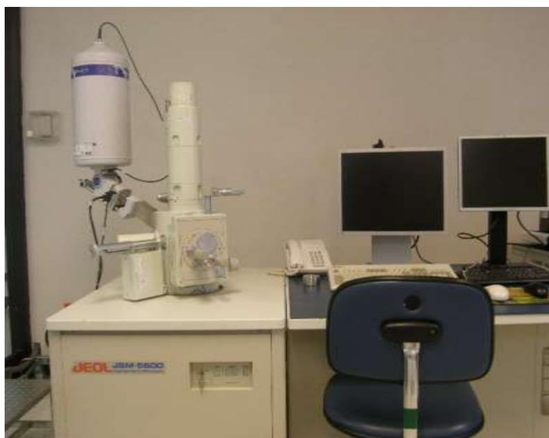
**Figura 4.10.** Equipo de microscopía electrónica de barrido equipado con EDS utilizado para la evaluación cuantitativa de las fases Intermetálicas.
