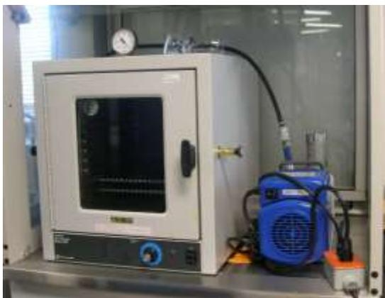
**Figura 4.11.** Equipo utilizado para la realización de los tratamientos térmicos.
