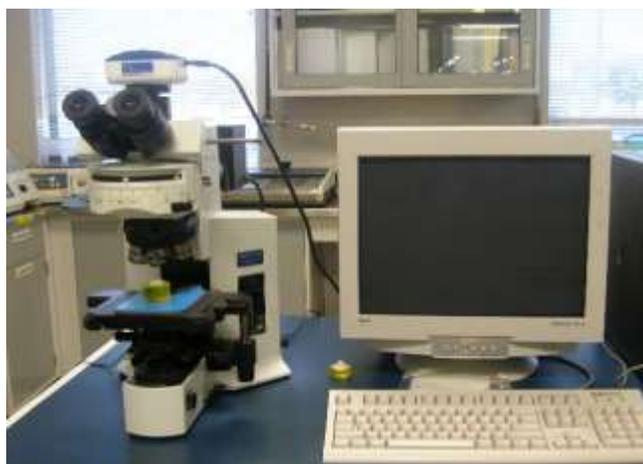
**Figura 4.9.** Equipo de microscopía óptica utilizado para la evaluación de las uniones preparadas metalográficamente.
