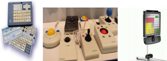
Figura 6. Teclado expandido IntelliKeys, Modelos de mouse e sistema EyeMax de controle do computador por movimento ocular.
