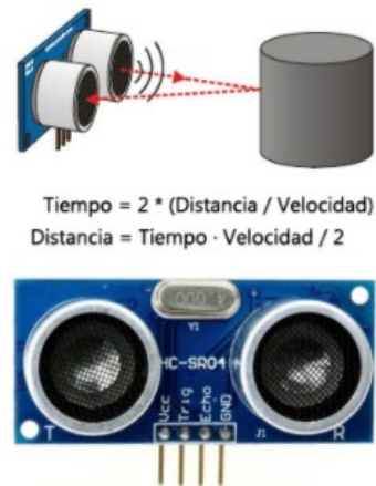
Ilustración 6 Sensor ultrasonidos distancia HC-SR04 (Tecnopatafísica, 2016a)
