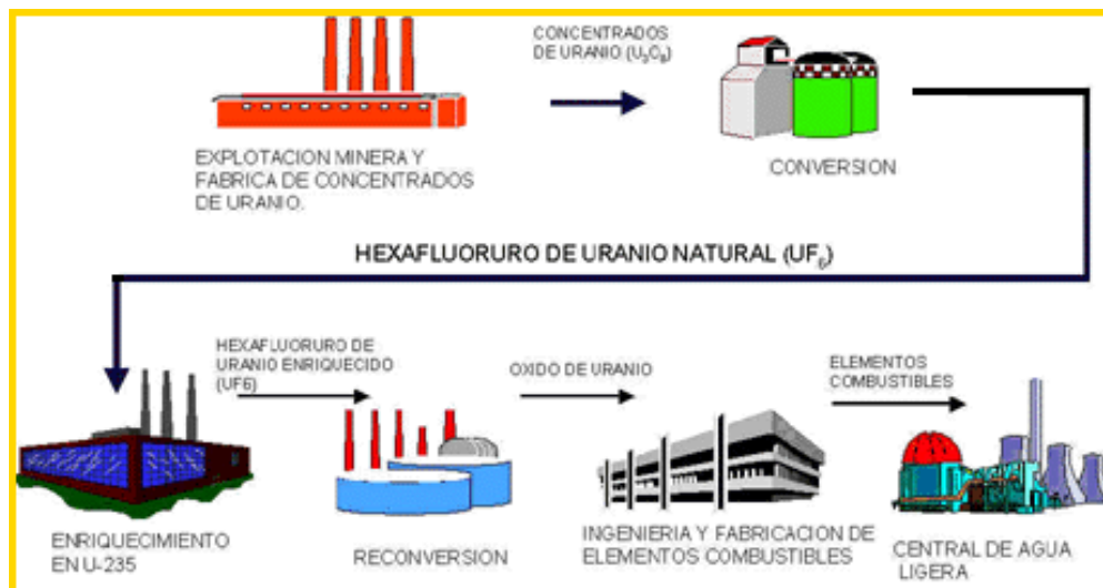
Figura 14. Esquema obtención combustible nuclear (Ministerio Para La Transición Ecológica y El Reto Demográfico, s.f. ).
