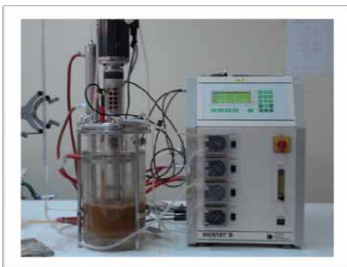
Fig. 4. Fermentation of sweet sorghum in fermentor (Kaewkannetra et al., 2008)
