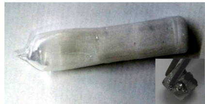
Abbildung A.3: Die Temperatur war zu lange bei 1200°C, das Quarzglas hat sich stark verformt.
