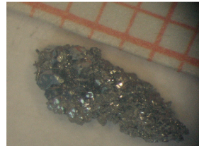
Abbildung A.1: Eine zu schnelle Abkühlrate führte zu sehr kleinen Kristallen (Photographie: eine frühe CeTiGe 3 Züchtung).
