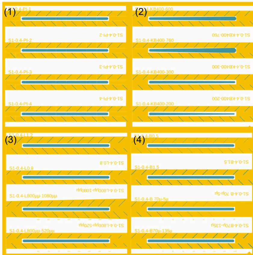
Abb. 6-41: Ausschnittsvergrößerung des Waferlayouts. Sichtbar sind die Grundstruktur (1), Variationen der Kanalbreite (2), Lamellenlänge (3) und -breite (4).
