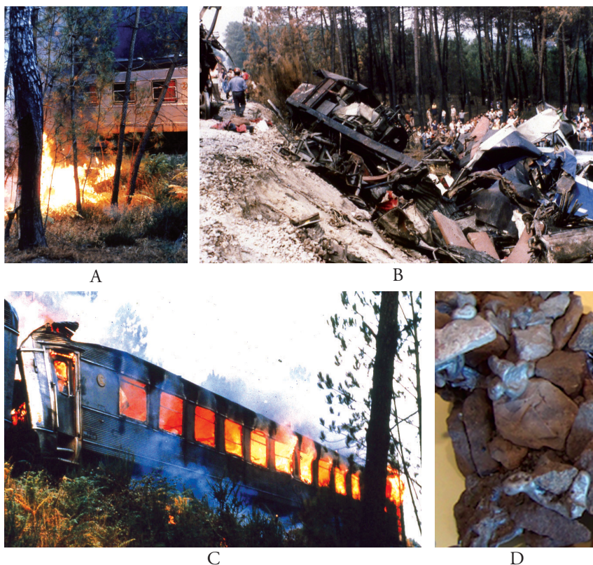
Fot. 4 - Carruagens a arder e propagação do incêndio à floresta envolvente: a) Pormenor da propagação do fogo duma carruagem para a vegetação circundante; b) Restos de carruagem destruída e pormenor do pinhal queimado; c) Vista geral duma carruagem em chamas, da qual se libertou alumínio derretido que pegou fogo à vegetação; d) Pormenor do alumínio derretido que solidificou nas pedras da brita da via férrea, recolhidas e religiosamente guardadas pelo Comandante Pais Borges (Fotografias de A. Ribeiro de Almeida (a, b, c) e de Sofia Bernardino (d)).
