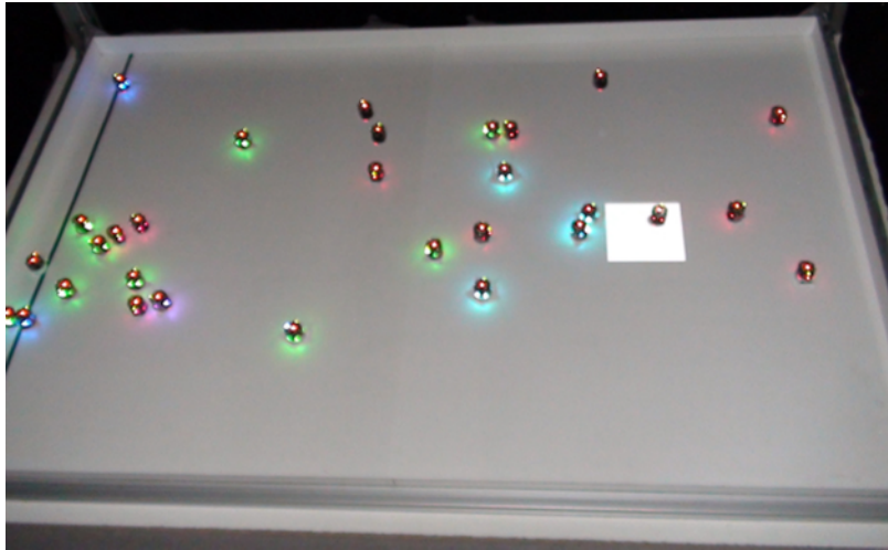
Abbildung 6.5: Aufbau der Arena ohne Wand: links am Rand ist der schwarze Streifen für den Ablagebereich, rechts sieht man die mit dem Projektor projizierte Ressource als helles Rechteck. Die verschiedenen Farben der Roboter stellen verschiedene Zustände im Verhalten der Roboter dar [67].
