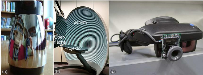
**Abbildung 5.11:** Stark gekrümmte spiegelnde Oberflächen bilden einen großen Winkelbereich des umliegenden Raumes ab (a); Aufbau zur deflektometrischen Untersuchung solcher Oberflächen (b); Prototyp eines HMD zur interaktiven visuellen Inspektion (c).
