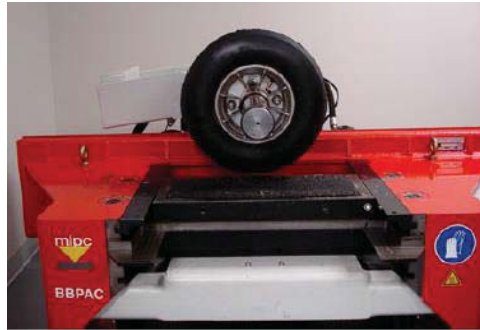
Figure 6. Photo of the Laboratoire Central des Ponts et Chaussées (LCPC) slab compactor.
