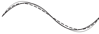
Abbildung 3.5: Numerische Lösung (durchgezogen) der exakten DGL, nachträgliche Spline-Approximation (gestrichelt) der numerischen Lösung und vorge-schlagene Spline Approximation (gepunktet)
