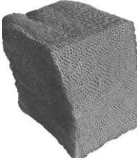
**Abb. 2.5.:** Keramische Struktur mit Mikrokanälen [55]
