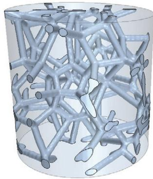
**Abb. 4.2.:** Zylinder aus Metallschaum
