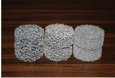
**Abb. 3.1.:** Metallschäume mit unterschiedlicher Porendichte
