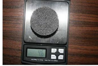
**Abb. 2.11.:** Messung des Gewichts eines 30 ppi Metallschaumes
