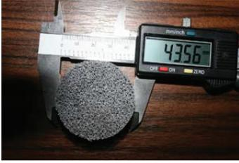
**Abb. 2.10.:** Messung des Durchmesser der Metallschaumprobe
