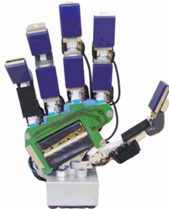
(b) Dieselbe Roboterhand nach dem Umbau – mit taktilen Sensoren und Positionssensoren.
