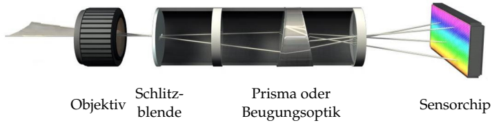
Abbildung 2.7 Hyperspektrales Messprinzip nach der Pushbroom-Methode. Durch die Beugungsoptik wird das Licht aufgefächert, der Sensor kann somit das Bildsignal einer Zeile räumlich und spektral aufzeichnen.
