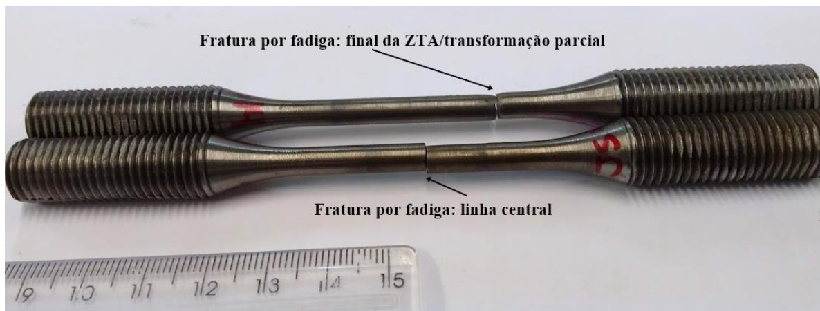
Figura 5.42 – Fotografias ilustrando a região de fratura por fadiga em corpos de prova de aço perlitico para trilhos ferroviários soldados por FBW.
