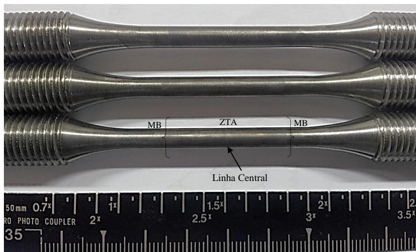
Figura 4.14 – Corpos de prova para ensaios de fadiga referentes à solda, evidenciando-se a ZTA revelada por Nital 2%.
