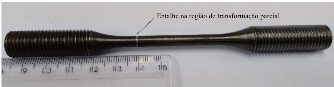
Figura 4.15 – Corpos de prova para ensaios de fadiga referentes à solda com entalhe na região de transformação parcial da ZTA.
