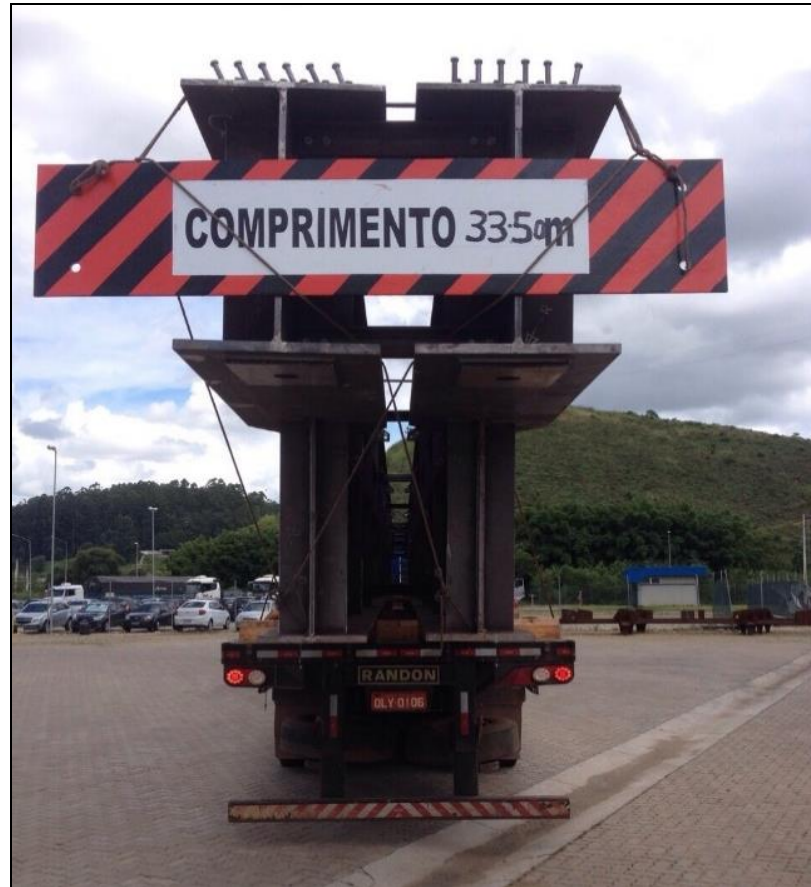
Figura 2.10 – Longarinas de uma ponte metálica sendo transportadas em carretas extensivas. Fonte: acervo técnico do autor.
