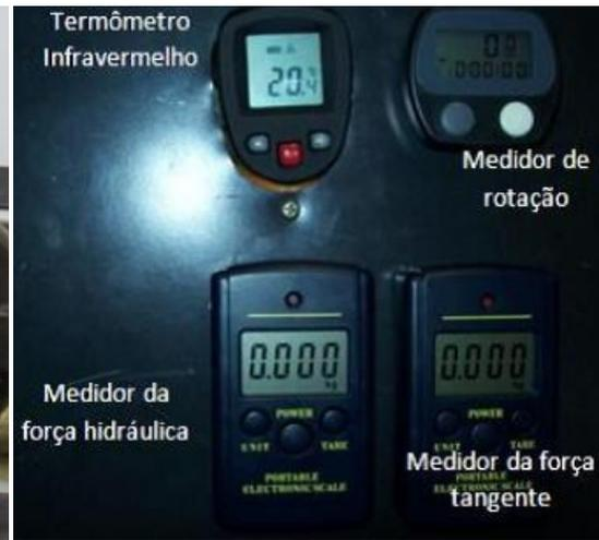
Figura 4: Painel de instrumentos
