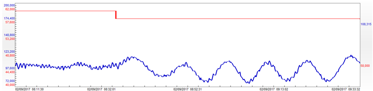
Figura 46: Comportamento da taxa de retorno no teste de rotação: 2º cenário, degrau de 60 Hz para 58 Hz
