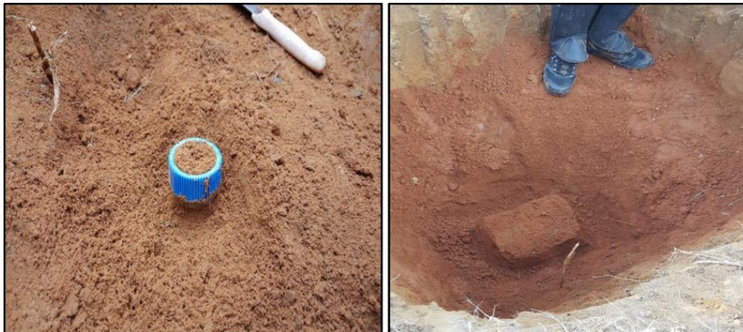
Figura 4.2 Coleta de amostras em anéis de PVC e em bloco.
