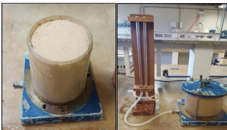
Figura 4.5 Montagem do ensaio de permeabilidade.
