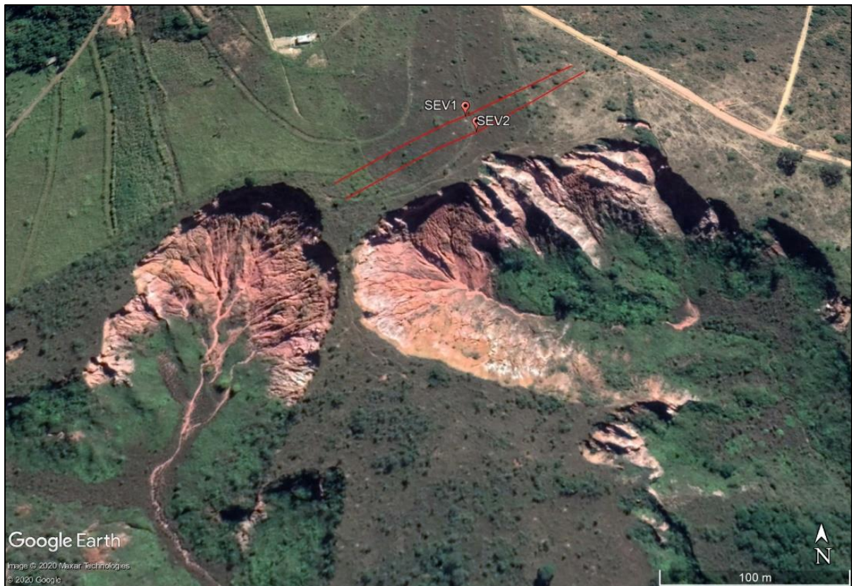
Figura 4.14 Localização das sondagens elétrica verticais (SEVs) na área de estudo. A voçoroca estudada foi a da direita, que apresenta o setor noroeste com os taludes mais instáveis. Os taludes na parte norte e nordeste da voçoroca se encontram mais estáveis, o que é evidenciado pela presença da vegetação. (Fonte: Google Earth).
