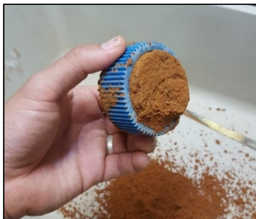
Figura 4.7 Moldagem dos corpos de prova para ensaio do papel filtro
