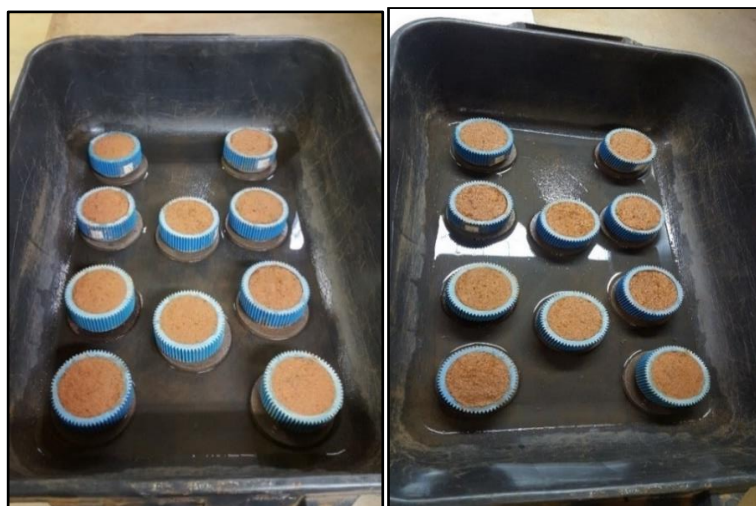
Figura 4.8 Saturação dos corpos de prova por capilaridade.
