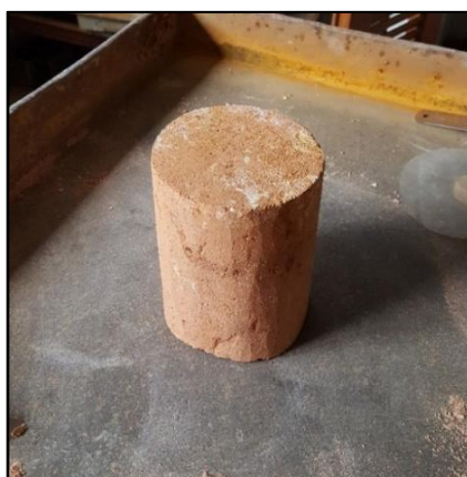
Figura 4.4 Preparação do corpo de prova do ensaio de permeabilidade.
