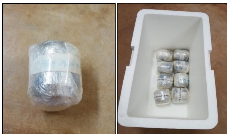
Figura 4.9 Amostras após montagem e colocação do papel filtro.
