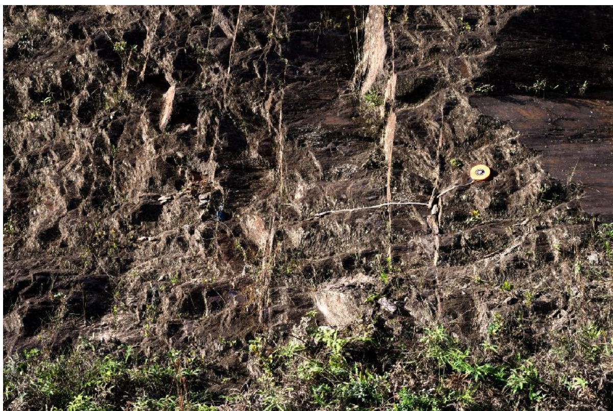
Figura 21: Maciço rochoso do ponto amostrado Rodrigo Silva. Detalhe para os planos subverticais das discontinuidades (trena comprimento 1m).
