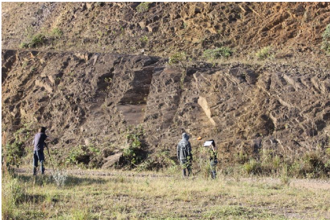
Figura 12: Captura de imagens utilizando tripé, câmera acoplada e escala de fita métrica.
