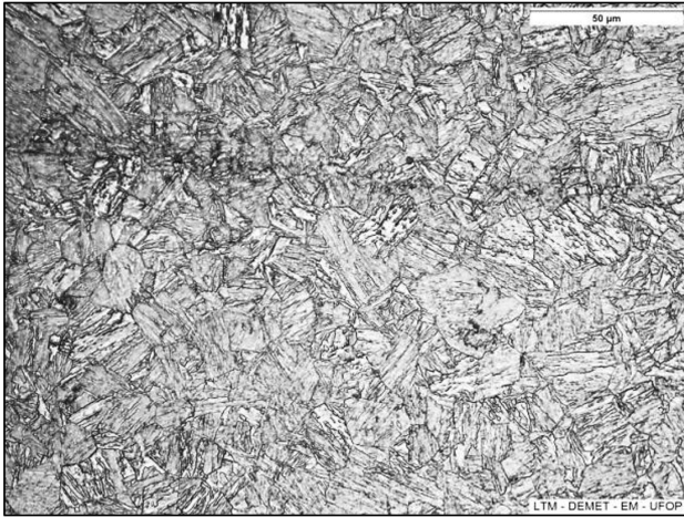
Figura 1. Microestrutura do estado de entrega temperado e revenido do aço USISAR 80T. Ataque nital 2%. 500x.
