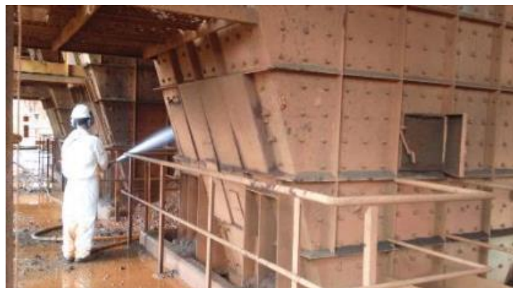
Figura 2. Interrupção do fluxo devido a obstrução de chutes por minério coesivo em uma das usinas da Mina do Pico.
