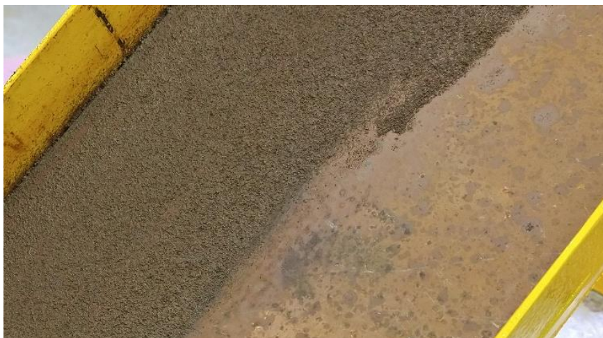
Figura 58. Partículas aderidas à superfície após aplicação do aditivo reológico Slipcoat MRA™ Max.
