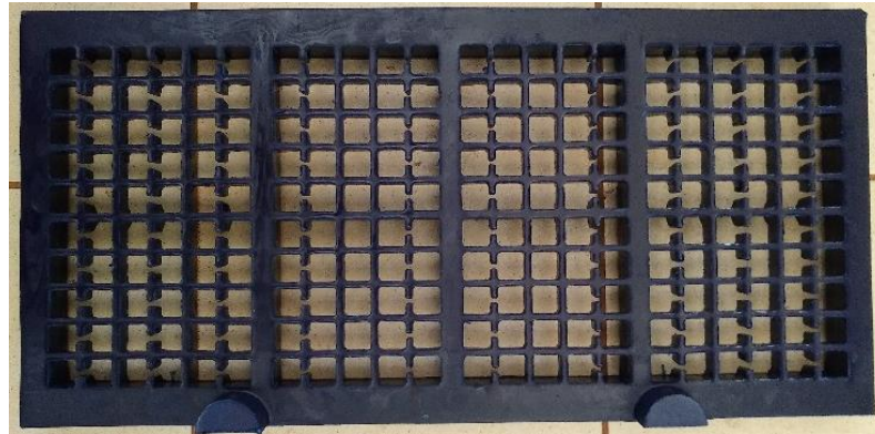
Figura 36. Tela em poliuretano autolimpante, abertura 19,0 mm.
