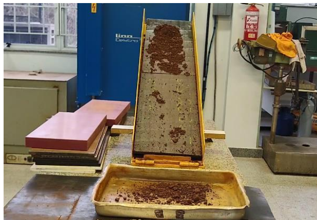
Figura 55. Eficiência de escoamento considerando aplicação de aditivo reológico Slipcoat MRA™ Max sobre revestimento CDP.
