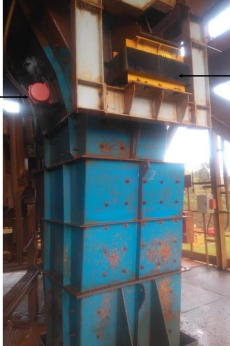
Figura 26. Isoamortecedor e motovibrador aplicado em chute de transferência.
