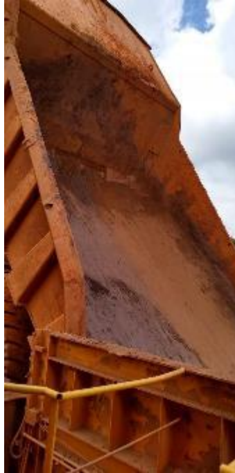
Figura 1. Material coesivo aderido à caçamba de caminhão fora de estrada durante operação de basculamento no britador primário.
