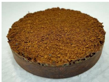
Figura 45. Disco de madeira com partículas de minério coladas em uma das faces para avaliação do coeficiente de atrito cinético.
