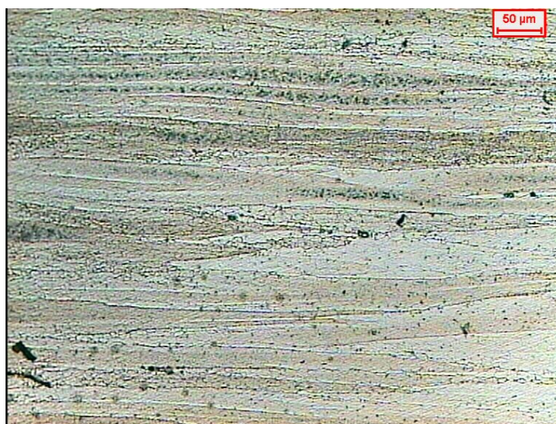
Figura 2: Microestrutura da liga Al 7475-T7351, 3% de estiramento. Ataque Keller. 200X.
