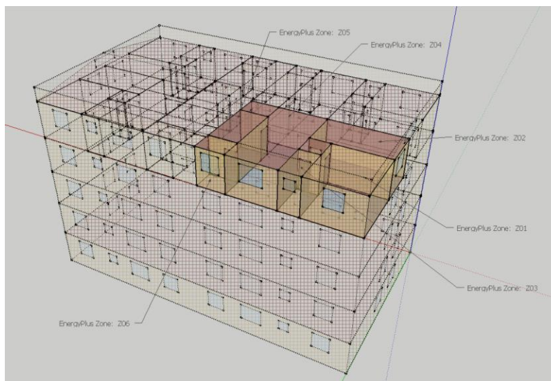
Figura 2 - Modelo tridimensional da edificação com a localização das zonas térmicas em análise
