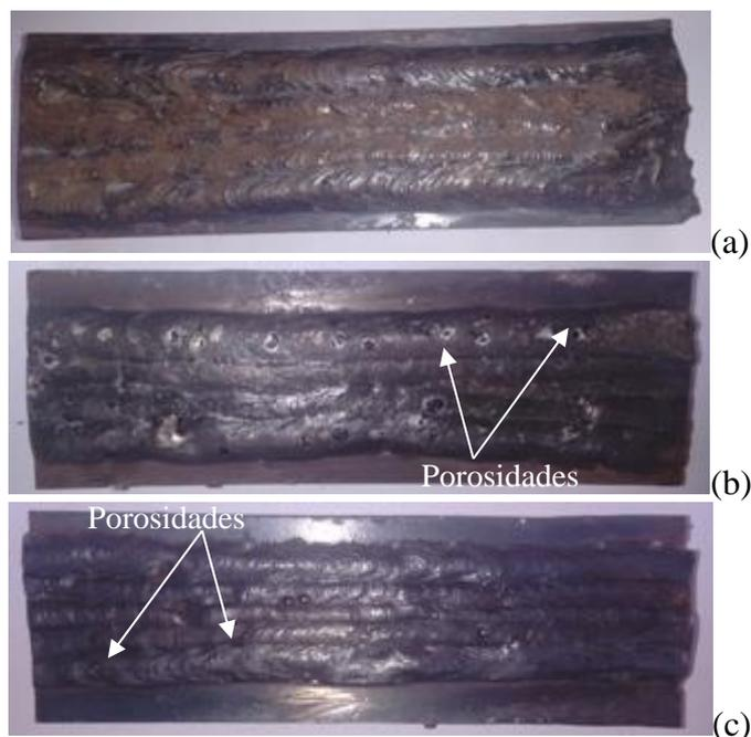
**Figura 4.6** Revestimentos aplicados nos corpos de prova; (a) liga A; (b) liga B; (c) liga C.
