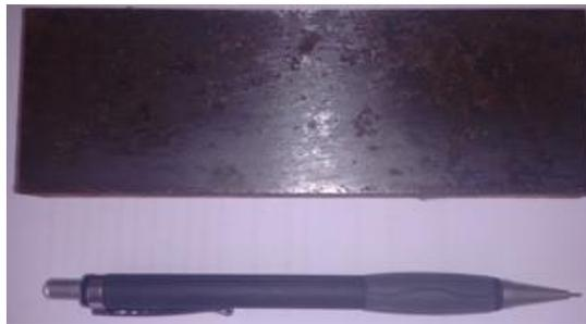
**Figura 4.4** Corpo de Prova (150 x 50 x 11,7mm)
