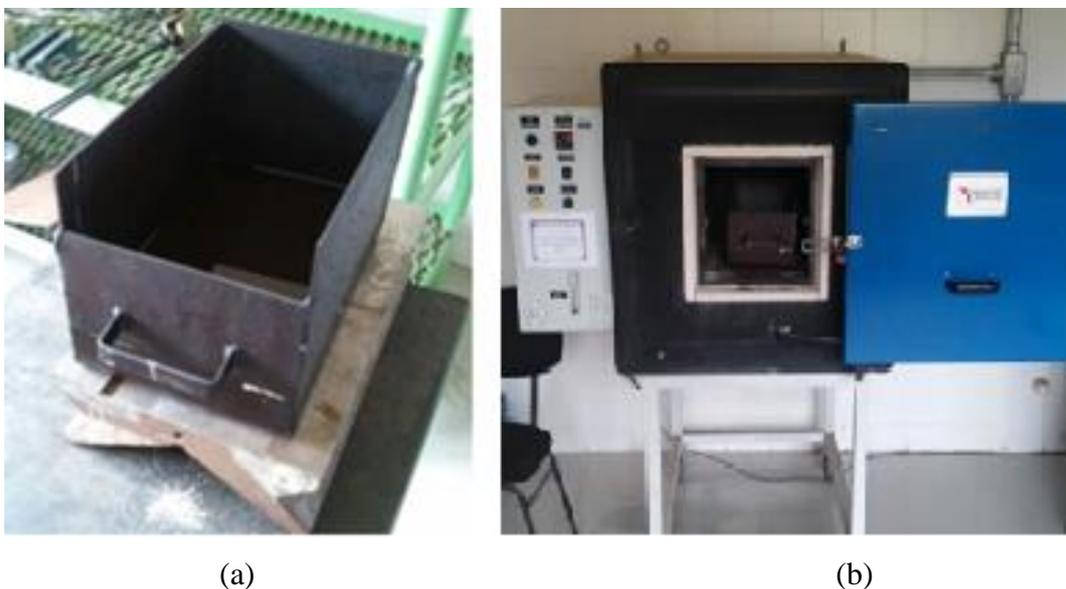
Figura 4.7 (a) Cuba de aço inoxidável empregada para realizar a têmpera em sal fundido de NaNO<sub>3</sub>; (b) Cuba posicionada no interior do forno.
