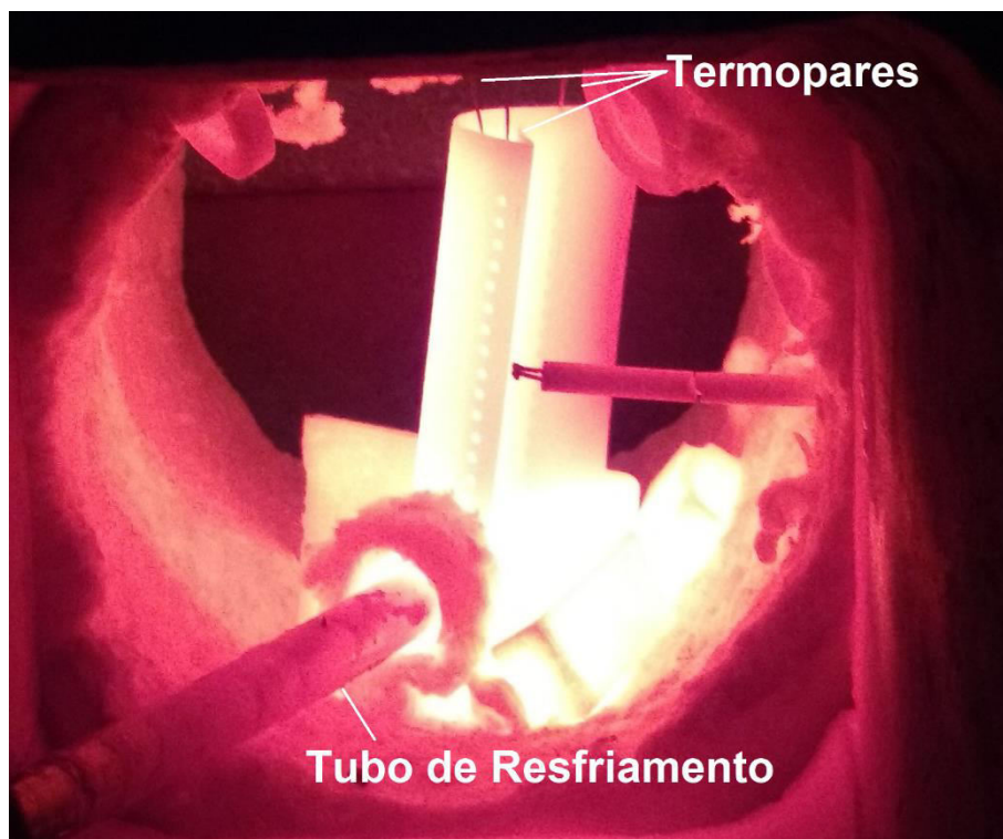
Figura 5.44 - Palheta com o tubo de resfriamento e os termopares
