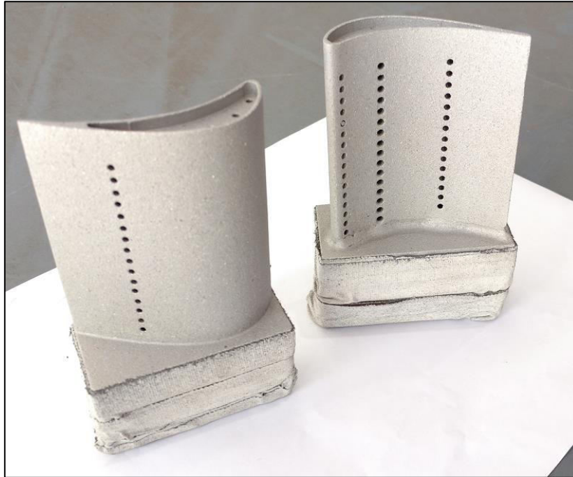
Figura 5.37 - Após o Jateamento Abrasivo
