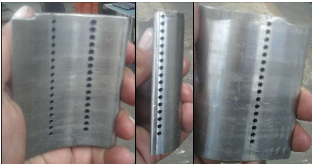
Figura 5.30 - Furação dos Canais de Formação do Film Cooling
