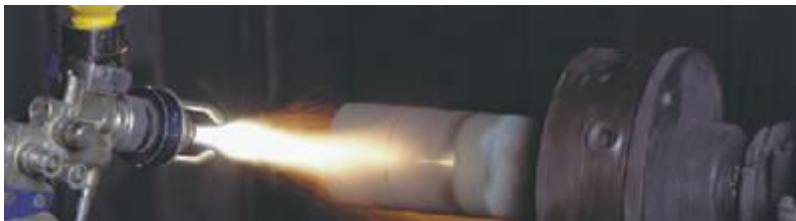
Figura 4.7 – Processo de Aspersão Térmica a Combustão (OGRAMAC, 2011)
