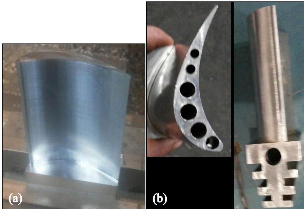
Figura 5.33 – (a) Usinagem do Aerofólio e (b) Furos de Resfriamento
