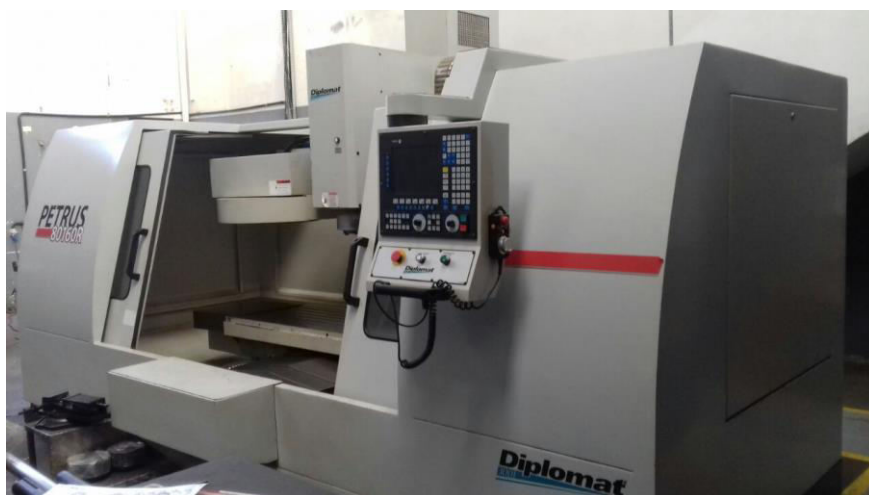
Figura 4.5 - Centro de usinagem PETRUS 80160 (PORTAL DAS MÁQUINAS, 2016)
