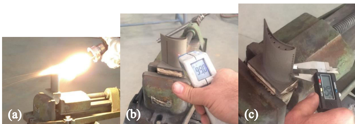
Figura 5.39 – (a) Aplicação Térmica ZrO_2 , (b) Verificando a Temperatura da Palheta e (c) Verificando a Espessura do Revestimento
