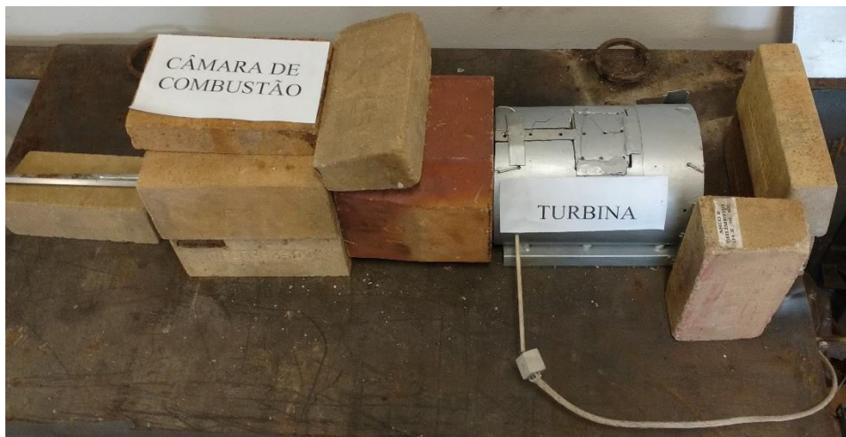
Figura 5.42 - Forno de Fluxo com Tijolos Refratários
