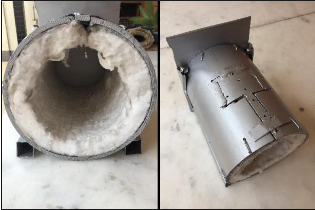
Figura 5.41 – Confeção do Forno de Fluxo
