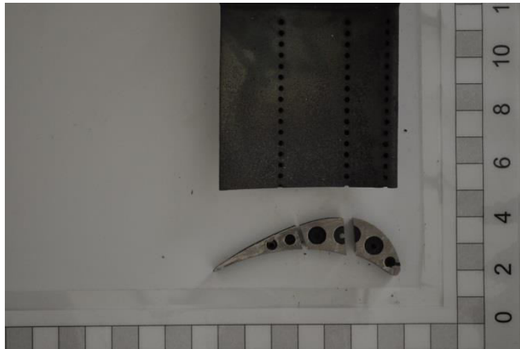
Figura 5.73 - Amostra retirada do topo da palheta após o experimento no forno
