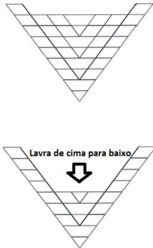
Figura 28 – Lavra tipo ‘Worst Case’ (adaptado de WHITTLE et al., 2006).
