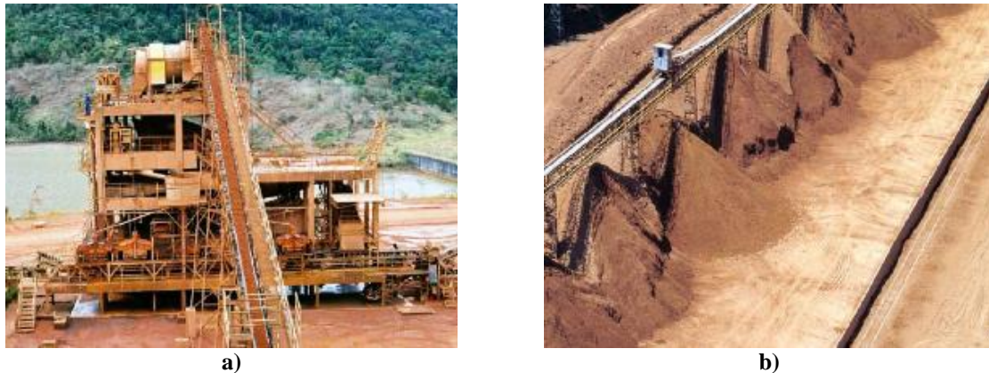
Figura 3.2 – Processo de beneficiamento da mina em Itamarati de Minas de propriedade da CBA sendo: a) Torre de beneficiamento; b) Área de estocagem de bauxita.
