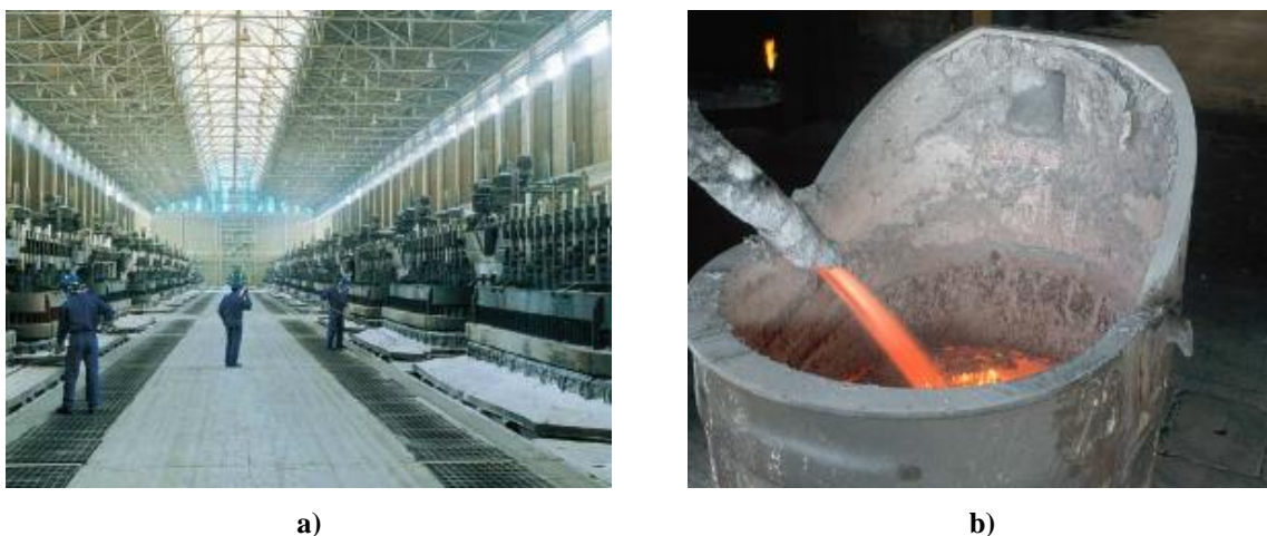
Figura 3.3 – a) Cubas eletrolíticas sequenciais de uma das salas fornos da CBA; b) Retirada do metal líquido da cuba por sucção e envio posterior para a etapa de fundição.
