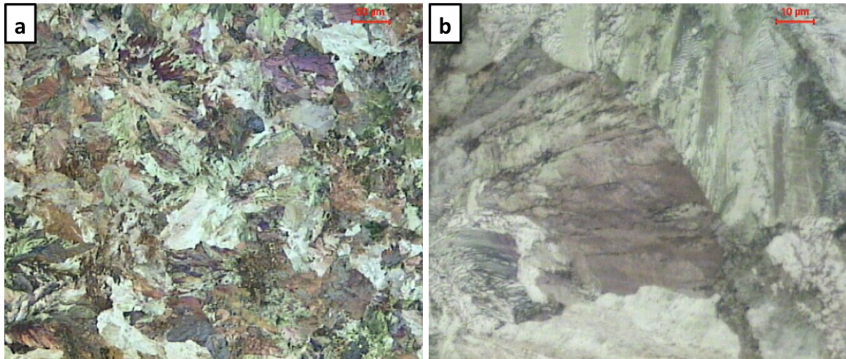
Figura 5.1 - Micrografia do aço A, no estado de entrega, ataque Nital 2%, (a) aumento de 200X; (b) aumento de 1000X - MO.
