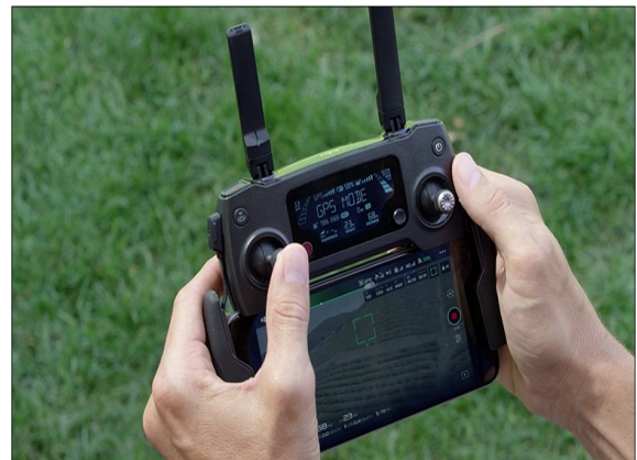
(b) Controle físico e aplicativo específico formam o GCS do Mavic Pro. Fonte: DJI, 2017c
