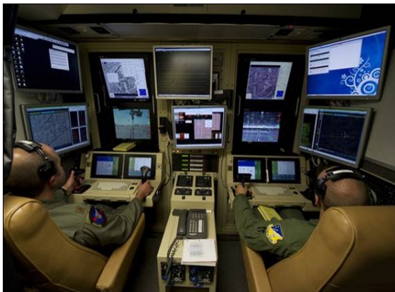
(a) GCS do MQ-9 Reaper, com diferentes funções e dois operadores. Fonte: SUBBARÁMAN, 2013
