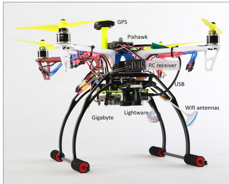
Figura 52 – Exemplo de um VANT real que utiliza a Camada de APIs AirLib . Fonte: LOVETT, 2017
