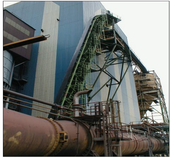
(b) Correia Sanduíche operando em grande inclinação. Fonte: DOS SANTOS INTERNACIONAL, 2017
