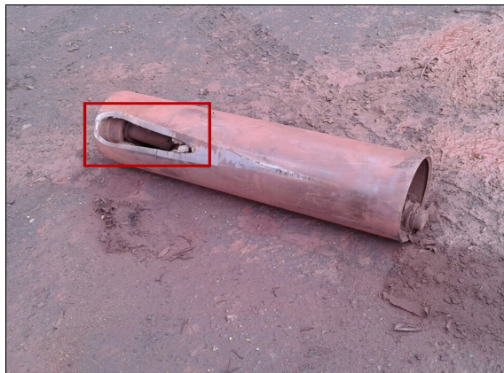
(a) Dano no revestimento do rolo
