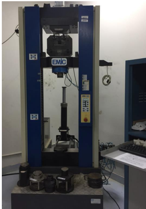
Figura 4.1 – Equipamento para ensaio de tração marca Instron EMIC 20000.
