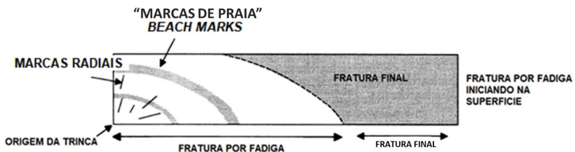
Figura 3.12- Representação esquemática de aspectos da fratura por fadiga (Adaptação de SCHIJVE, 2009).
