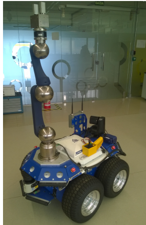
Figura 3: Robô usado como base da implementação: ‘Seekur Jr’, equipado com braço manipulador ‘Schunk Powerball’.
