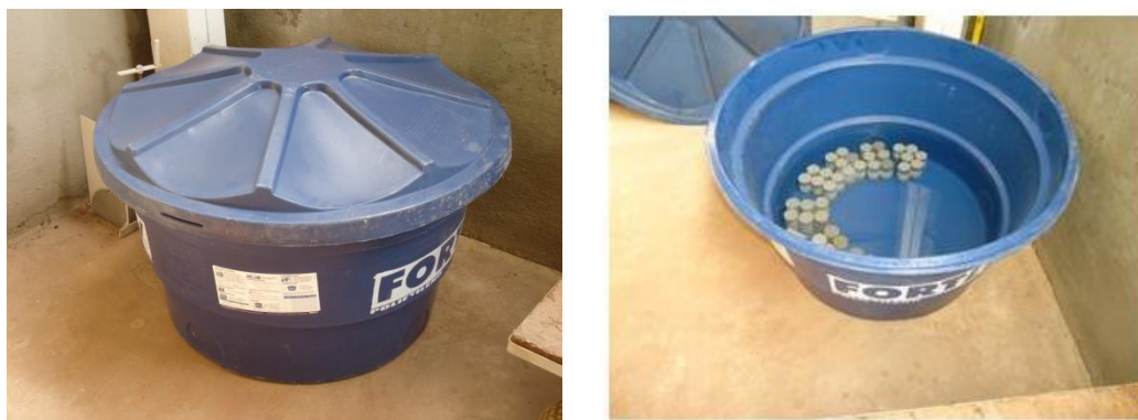
Figura 3.17 – Caixa d'água para imersão dos corpos-de-prova em água. Fonte: dados do autor, 2015
