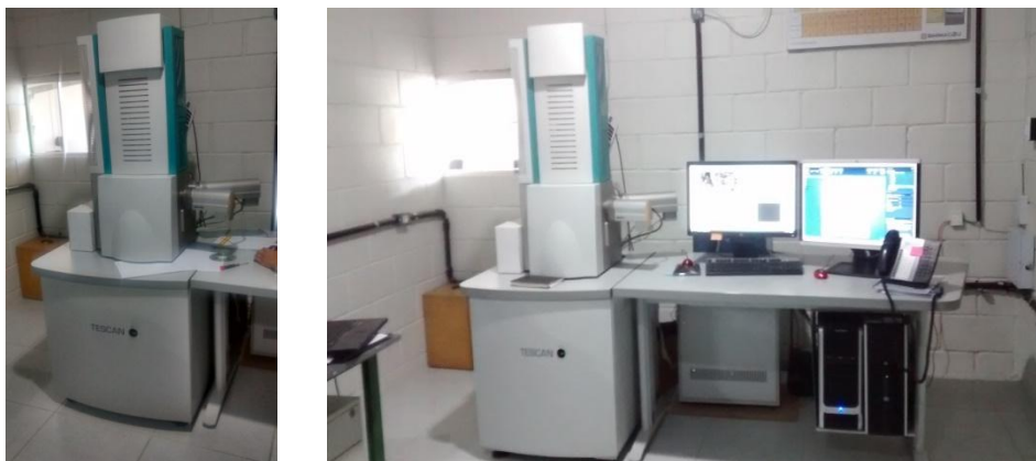
Figura 3.31 – Microscópio eletrônico de varredura da empresa Phosther Fonte: dados do autor, 2016
