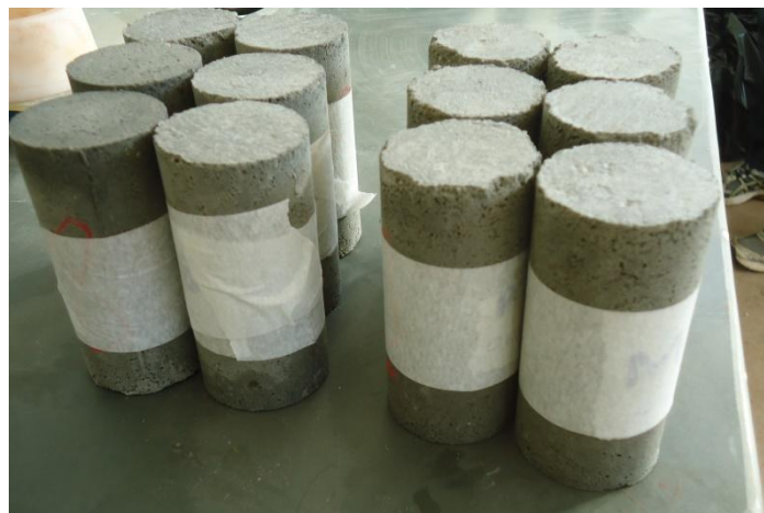
Figura 3.24 – Corpos-de-prova desmoldados e preparados para a imersão na água durante 28 dias. Fonte: dados do autor, 2015/2016
