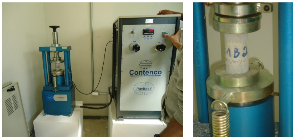
Figura 3.19 – Prensa elétrica hidráulica para compressão dos CP Fonte: dados do autor, 2015
