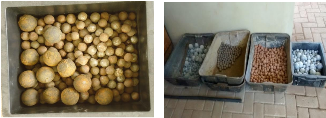
Figura 3.7 – Corpo moedor constituído de bolas de ferro fundido. Fonte: dados do autor, 2015
