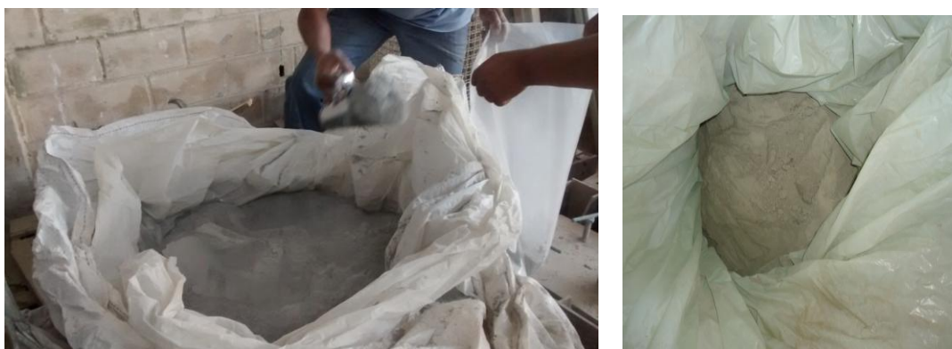
Figura 3.12 – Ardósia processada em moinho pendular em Itu-SP. Fonte: dados do autor, 2015
