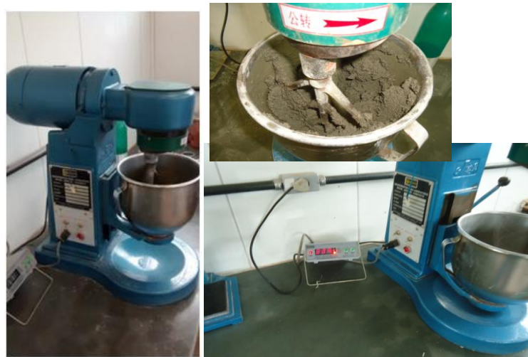
Figura 3.14 – Argamassadeira elétrica com comando temporizado. Fonte: dados do autor, 2015
