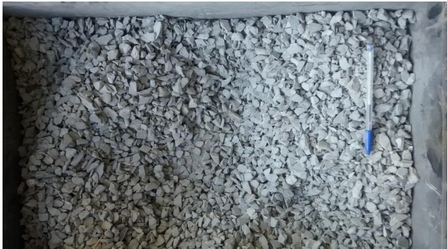
Figura 3.3 – Brita de ardósia usada nos experimentos da pesquisa. Fonte: dados do autor, 2015
