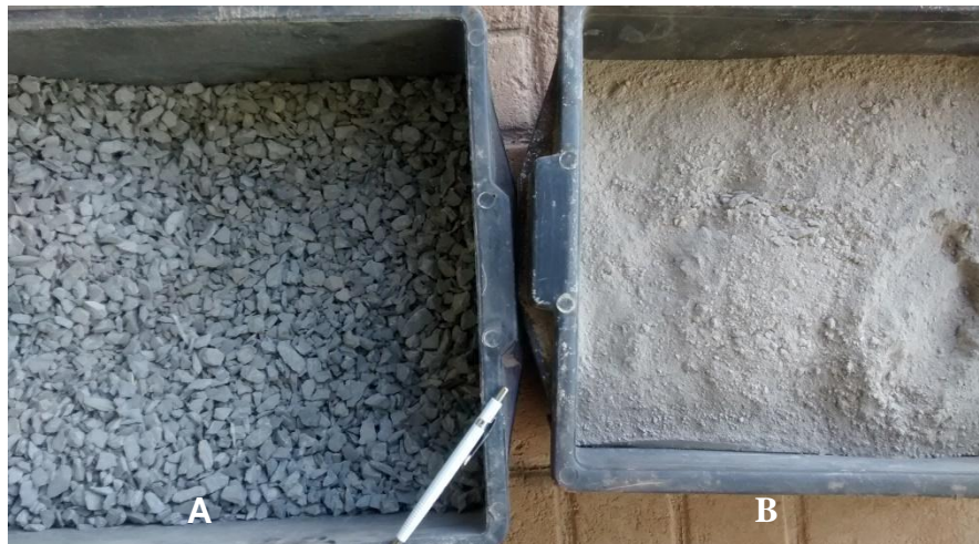
Figura 3.8 – Brita fina de ardósia (A) e Ardósia em pó (B) Fonte: dados do autor, 2015
