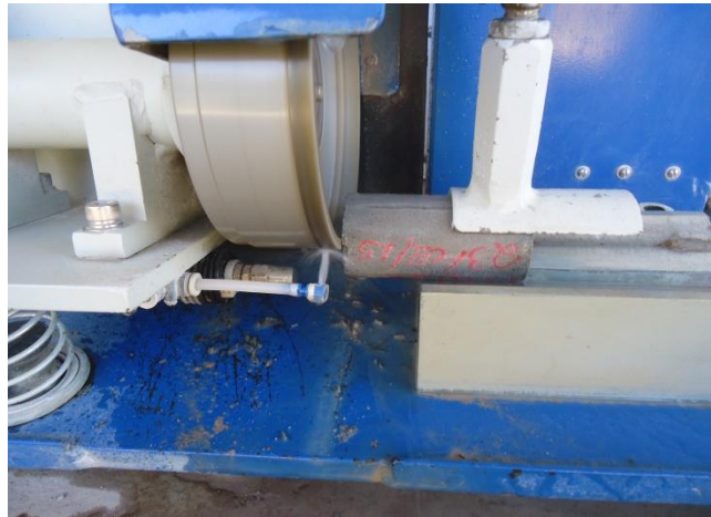
Figura 3.26 – Retificação de corpo-de-prova antes da ruptura Fonte: dados do autor, 2015
