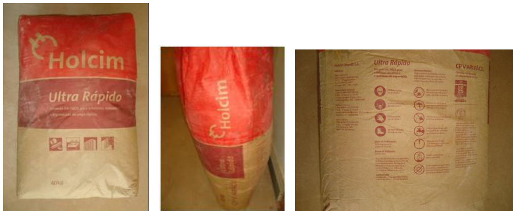
Figura 3.10 - Cimento Portland CP-V usado nos experimentos da pesquisa. Fonte: dados do autor, 2015
