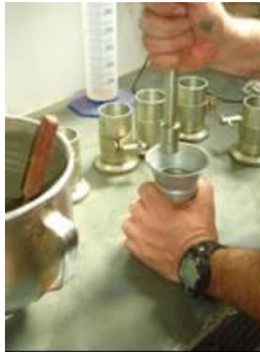
Figura 3.16 – Soquete para adensamento da argamassa no molde cilíndrico. Fonte: dados do autor, 2015/2016
