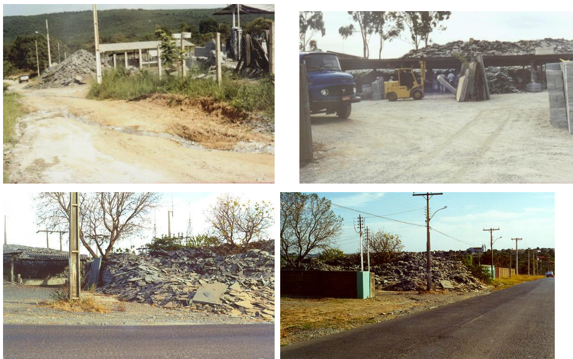
Figura 2.5 - Depósitos de rejeitos de serraria em vias públicas, formados de aparas e lama. Fotos do autor, 2000.
