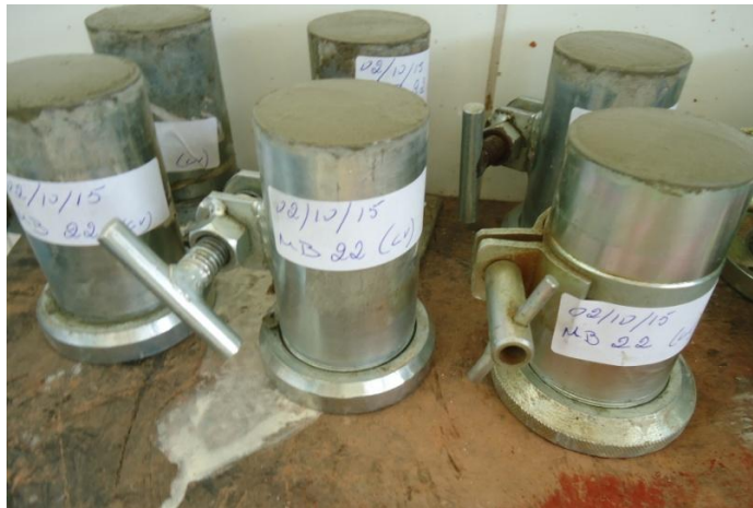
Figura 3.23 – Corpo-de-prova MB 22 pronto para a desmoldagem após o repouso de 24 horas. Fonte: dados do autor, 2015/2016
