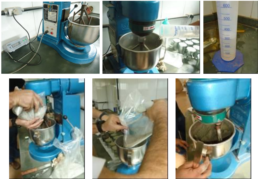
Figura 3.21 – Etapas relacionadas com a mistura dos componentes da argamassa em estudo
