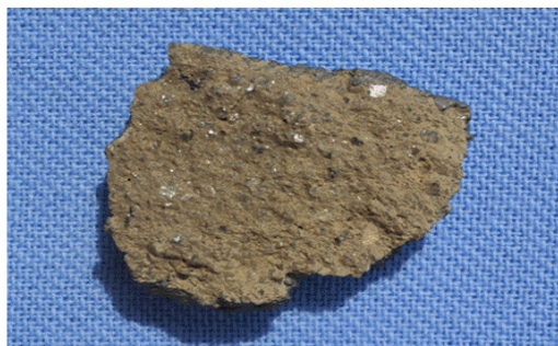
Figura 4.11 – Superfície de ruptura da amostra MB 20 Fonte: dados do autor, 2016
