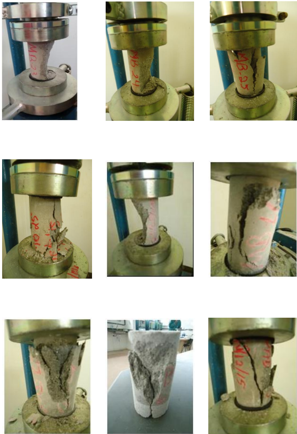
Figura 4.2 – Morfologia de corpos-de-prova resultantes da ruptura na prensa hidráulica.
