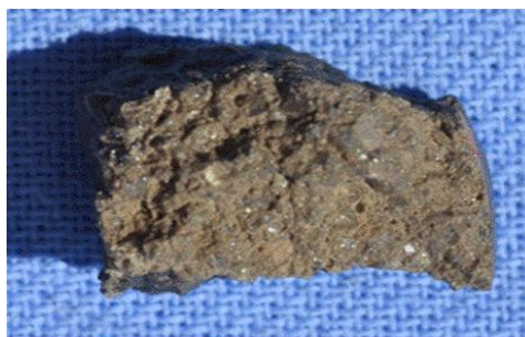
Figura 4.39 - Superfície de ruptura da amostra padrão P20-21
