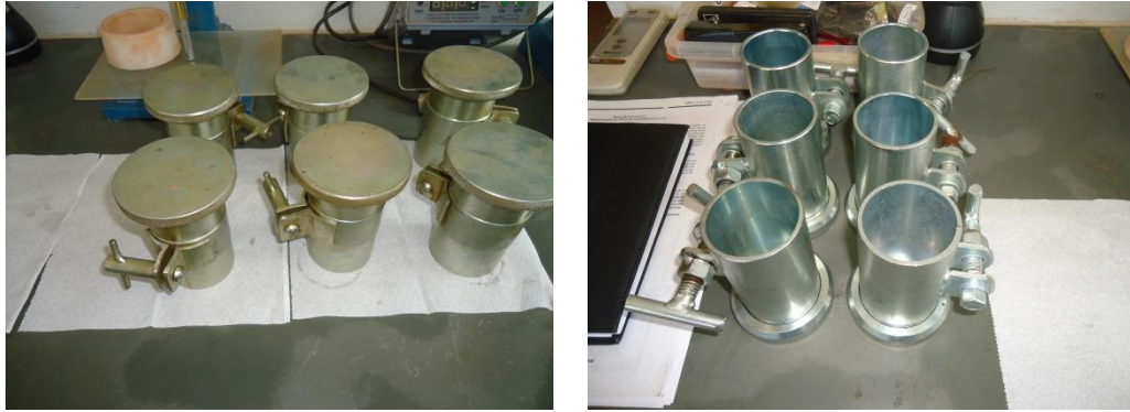
Figura 3.15 – Moldes metálicos com dimensões 50 x 100 mm, para elaboração de corpos-de-prova. Fonte: dados do autor, 2015
