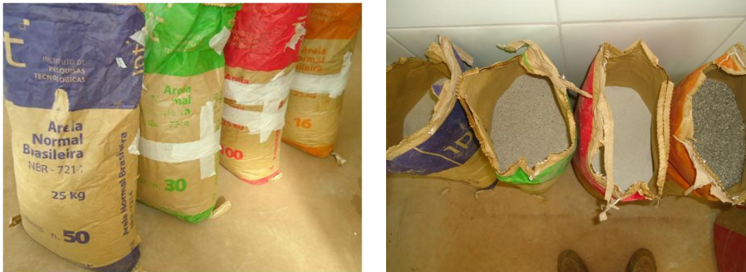
Figura 3.9 - Areia Normal Brasileira desenvolvida pelo IPT (NBR 7214) Fonte: dados do autor, 2015
