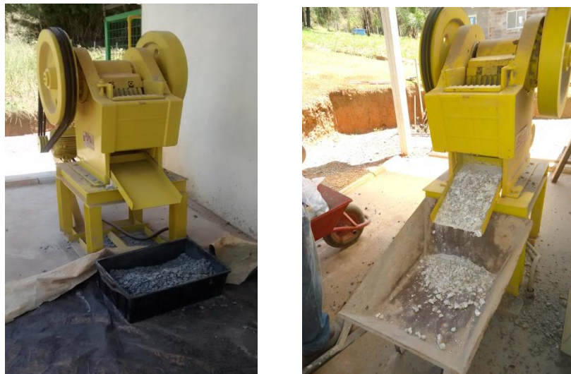
Figura 3.4 – Britador de mandíbulas reduzindo a granulometria da brita de ardósia. Fonte: dados do autor, 2015
