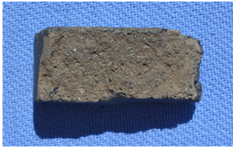
Figura 4.32 – Superfície de ruptura da amostra MB 25 Fonte: dados do autor, 2016
