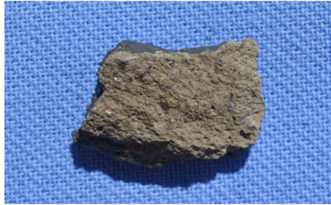
Figura 4.18 - Superfície de ruptura da amostra MB 21 Fonte: dados do autor, 2016
