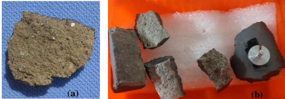
Figura 3.32 – Amostras de fragmentos de corpos-de-prova preparadas para MEV na UFMG Fonte: dados do autor, 2016
