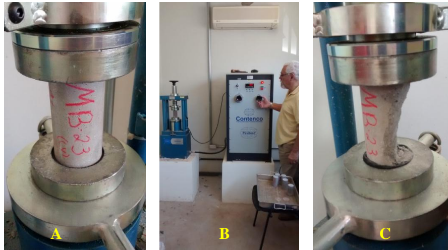
Figura 3.27 – (A) Detalhe do corpo-de-prova MB 23 na prensa. (B) Prensa hidráulica. (C) Corpo-de-prova após o seu rompimento
