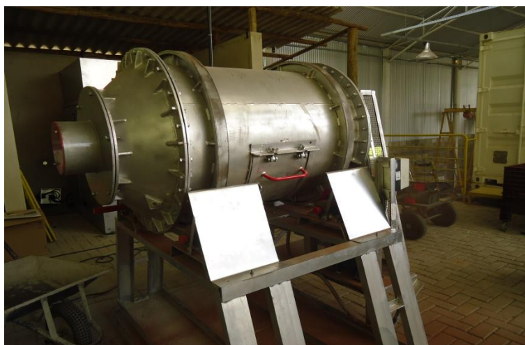
Figura 3.6 – Moinho de bolas utilizado para a cominuição da brita de ardósia. Fonte: dados do autor, 2014
