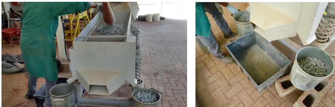
Figura 3.5 – Peneira vibratória separando as frações granulométricas da brita de ardósia. Fonte: dados do autor, 2015
