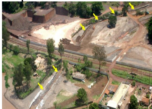
Figura 90 – Vista aérea do trecho reconformado da calha do Córrego Esperança, passando pelo TSA e sob a linha férrea até sua foz no Rio Paraopeba
