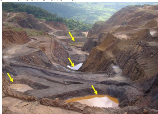
Figura 166 – Área onde era realizada a lavra antes da paralisação, com as estruturas de contenção de sedimentos e amortecimento do fluxo da drenagem pluvial funcionando de forma satisfatória
