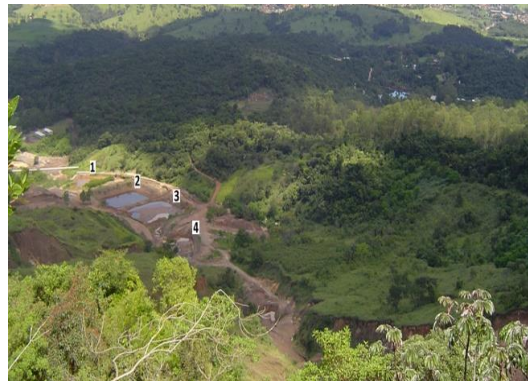
Figura 103 – Pequenas bacias ( sumps ) que foram escavadas à montante da antiga cava, com a função de amortecer a drenagem e reter sedimentos
