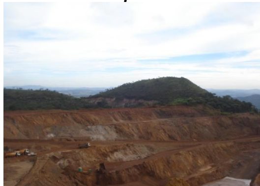
Figura 130 – Geometrização da encosta norte do pit de lavra
