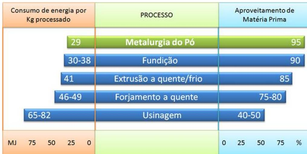
Figura 3.2 – Energia e matéria-prima utilizada em vários processos de fabricação (Grupo Setorial de Metalurgia do Pó, 2018)
