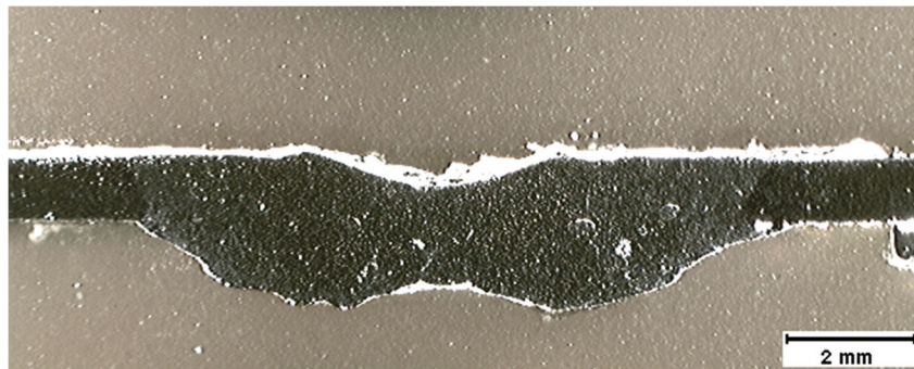
Figura 5.11 – Macrografia (10x) de cordão de solda da classe cratera. Seção transversal B-B do cordão de solda nº 31 – Figura 5.2. Fonte: Autor.
