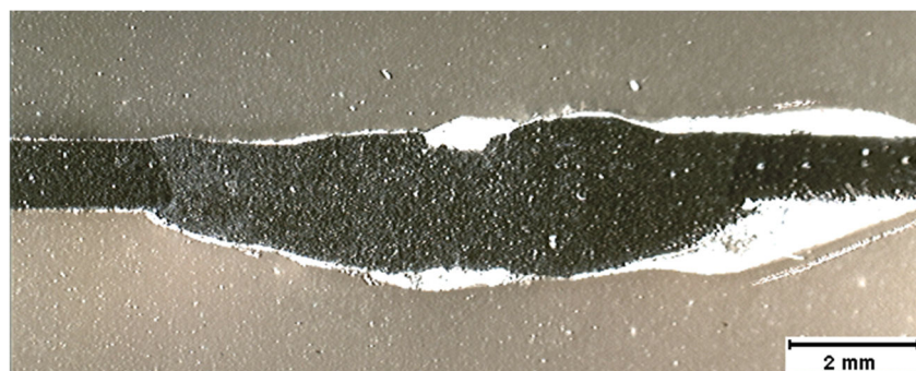
Figura 5.13 – Macrografia (10x) de cordão de solda da classe cratera. Seção transversal K-K do cordão de solda nº 27 – Figura 5.6. Fonte: Autor.
