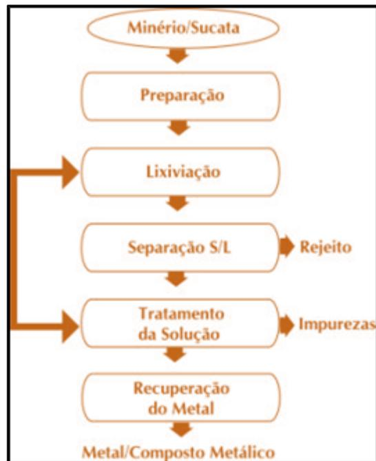
Figura 1.1: Fluxograma básico de um processo hidrometalúrgico.
