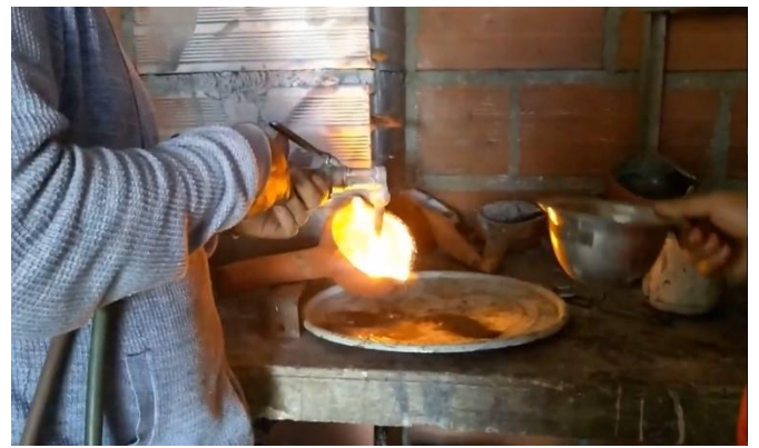
Fotografía 29: Secuencia del procedimiento de fundición a altas temperaturas. 1. Se pulveriza el oro antes de meterlo al horno. Sebastián al lado del horno prendiendo la llama en la que se funde. 2. El horno encendiendo. 3. El horno con la llama más potente. 4. Se vuelve a poner a un fuego más moderado.
