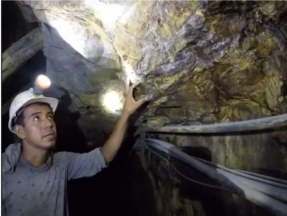
Fotografía 17: Rubén enseñando como se ve una aguja y una posible veta. Aseguro que ahí no hay nada, y que si lo hubiera igual sería muy poco, pues no se podría porque aún es la entrada de la mina. El oro se encuentra en la profundidad.
