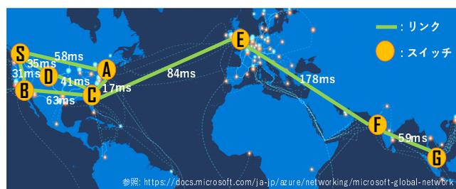
図 9 Mininet 上にビルドするネットワークポロジと伝搬遅延
