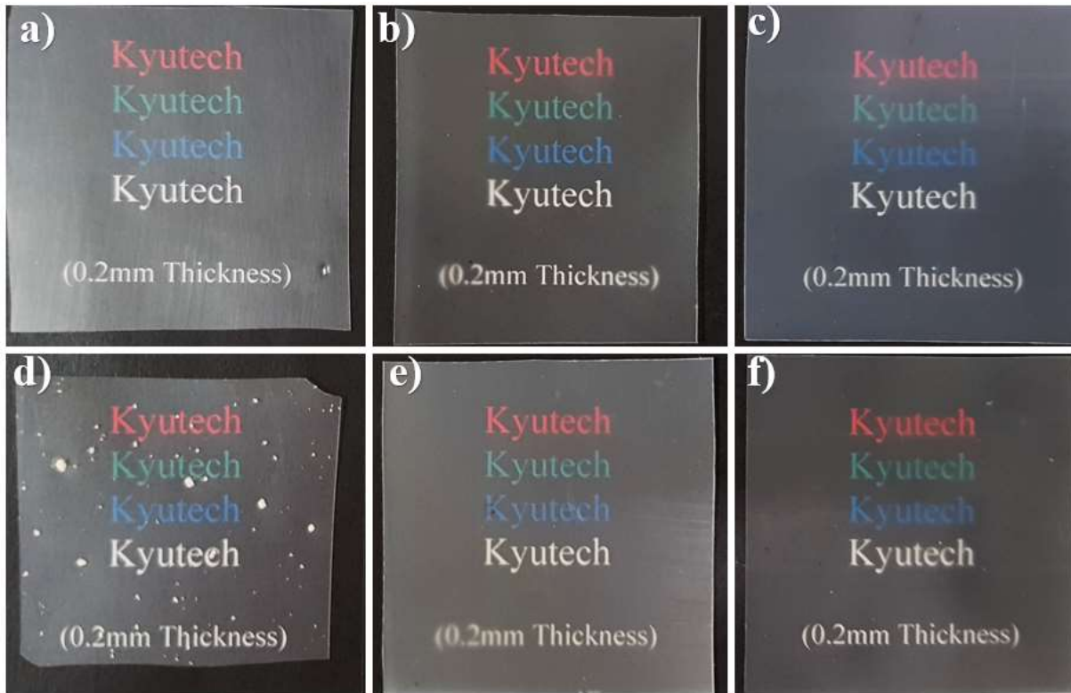
Figure 5.3: Morphological of PP composite (a) PP, (b) PP-8.75 pul.SS, (c) PP-8.75 pul.SP, (d) PP-1.25 pul.CNF, (e) PP- SS/CNF and (d) PP- SP/CNF
