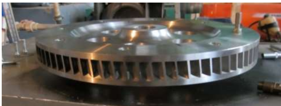
Рисунок 4.10 – Робоче колесо експериментальної моделі вихрової розширювальної машини
