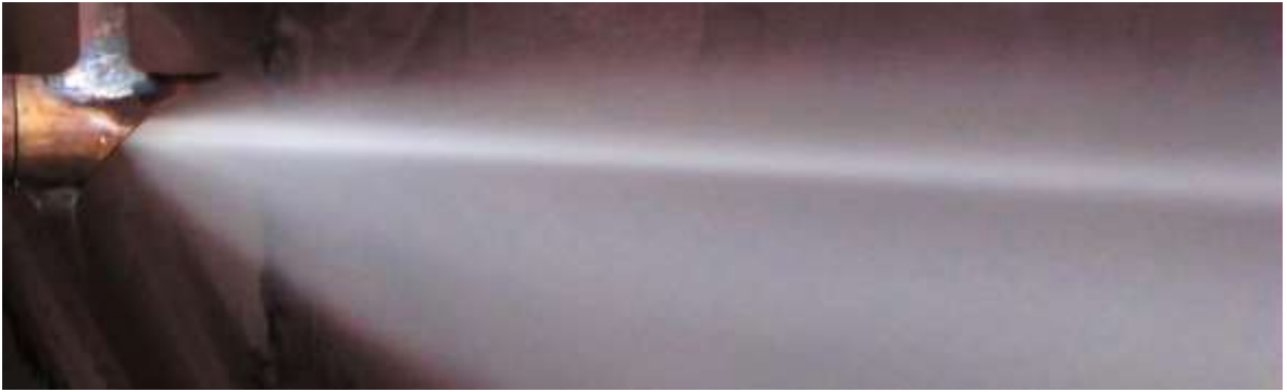
Рисунок 3.11 – Фотографія відхилення скипаючого потоку у косому зрізі сопла, що розширюється, при d_r = 2,3 мм, p_{01} = 5,04 бар, без недогріву
