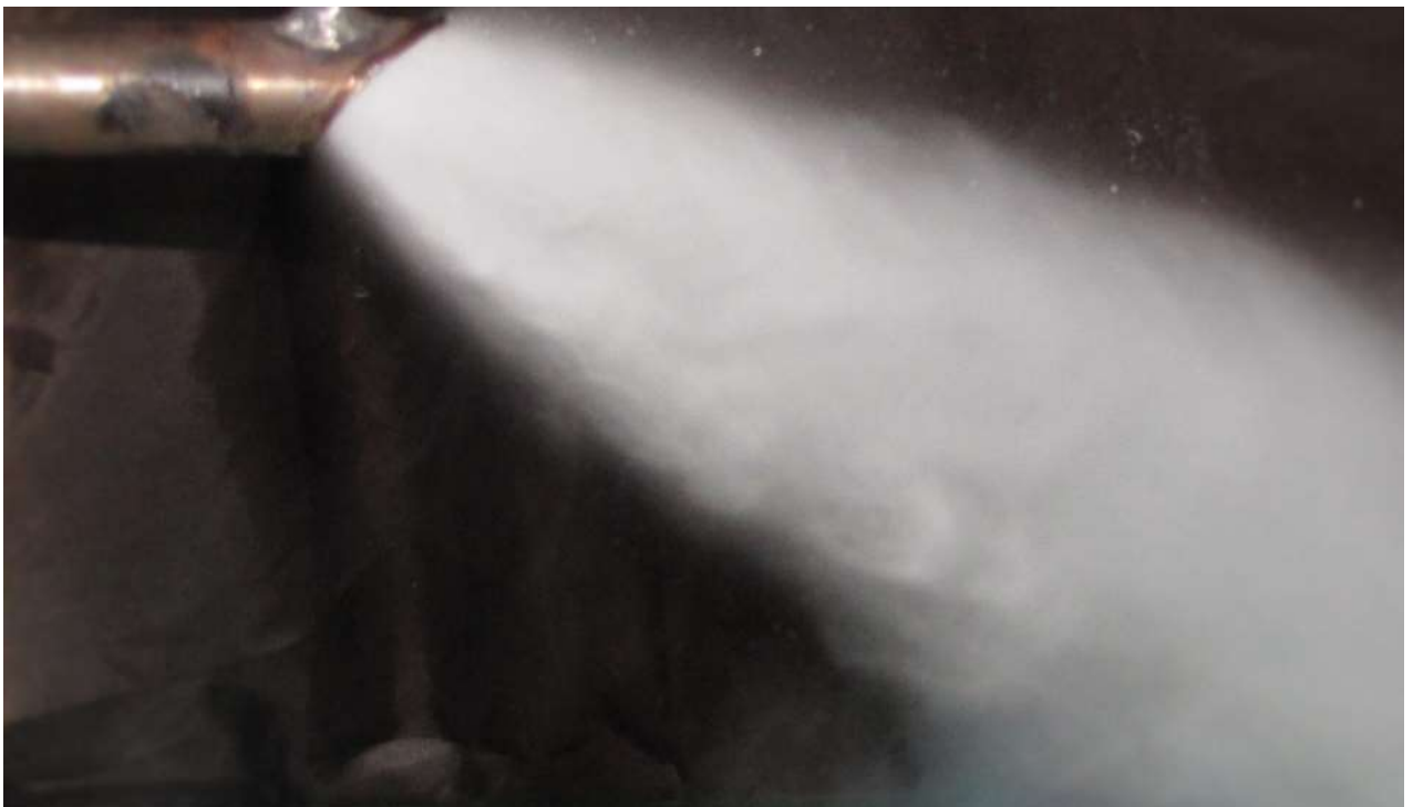
Рисунок 3.10 – Фотографія відхилення скипаючого потоку у косому зрізі сопла, що розширюється, при d_r = 4,1 мм, p_{01} = 5,04 бар, без недогріву
