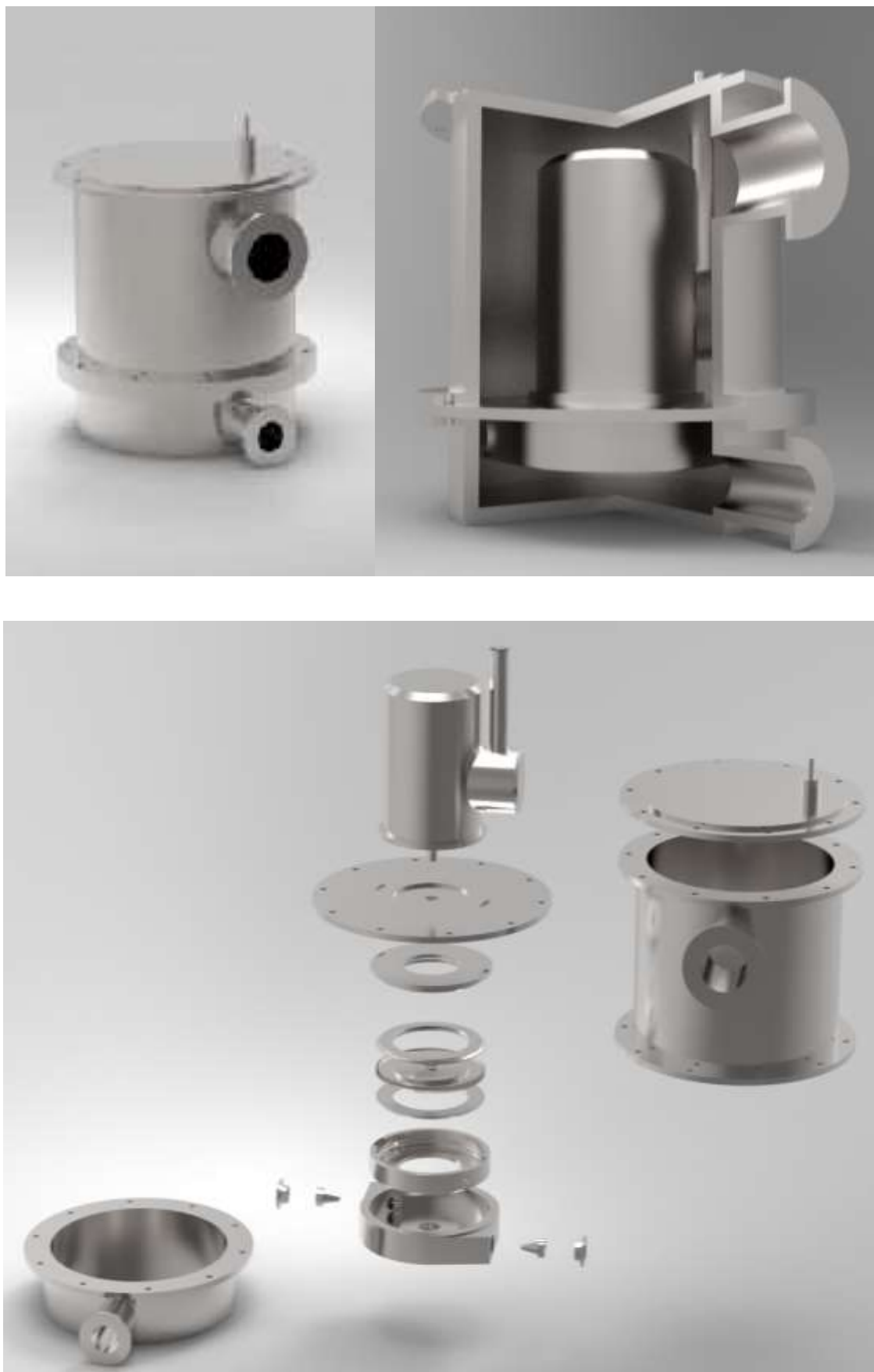
Рисунок 4.32 – Конструкція турбогенератора на базі вихрової розширювальної турбомашини.
