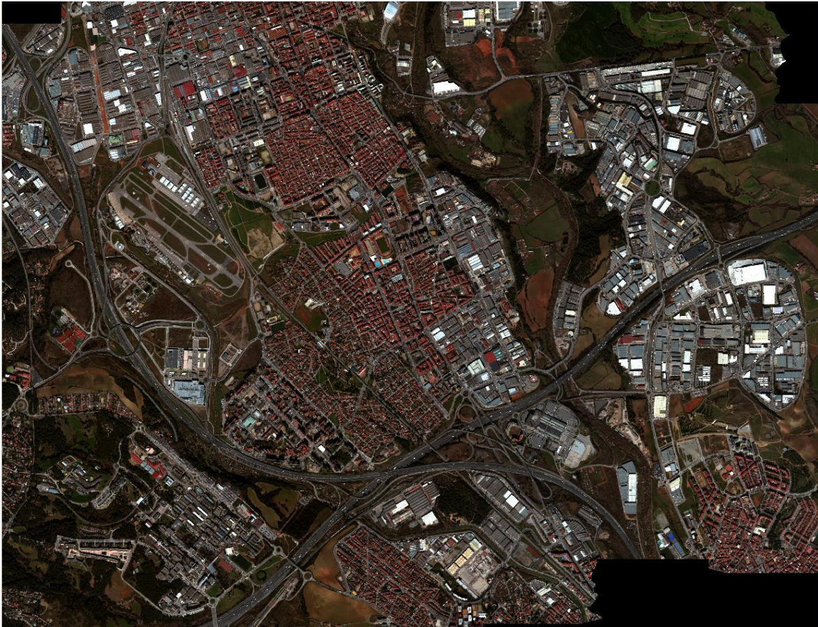
Figura 2. Mosaico y detalle de una imagen en falso color (usando bandas 127,63 i 34 de la tabla 2 y simulando una imagen RGB estándar) de reflectancias del AISA Eagle II correspondiente al vuelo del 3 de marzo de 2018 en el AOI.
