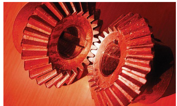
Figura 7. Engranatges cònics (Joseph et al., 2017).
