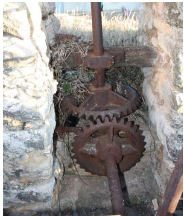
Figura 10. El rodent (roda horitzontal) fa girar la roda vertical que transmet el moviment a la roda de cadúfols. Imatge de https://www.catimenu.com/senia.htm .
