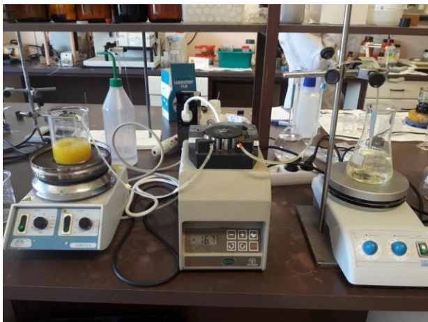
Figura 5: Procediment de preparació de les boles d'alginat de calci
