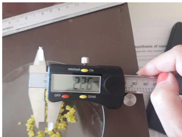
Figura 6: Mesura amb un peu de rei de les boles d'alginat de calci amb la pols de pela de mandarina dins.
